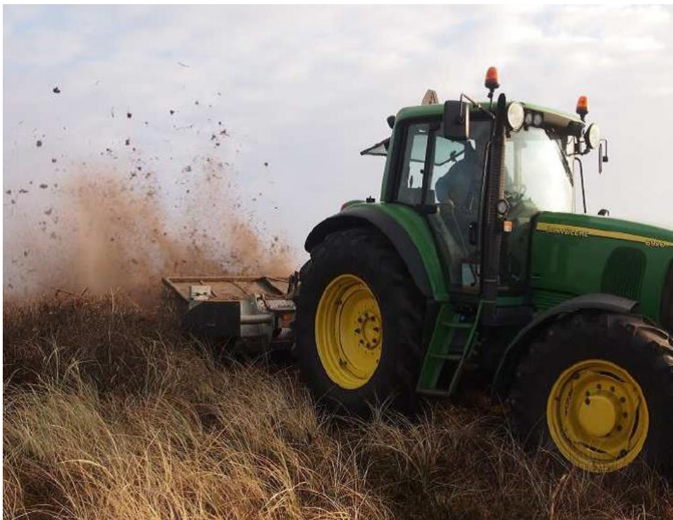
Billede 2. Fræsning af rynket rose med biorotor i klitområder. Foto: Naturstyrelsen.
